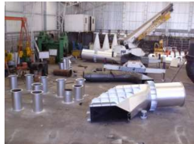
Fabricación de ductos de ascenso
