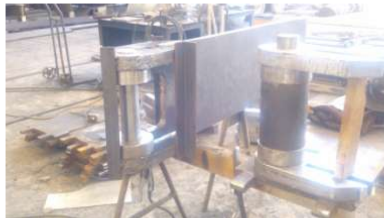
FABRICACION DE MUELLES EN PLACA DE 2" ESP. PARA SECADOR
