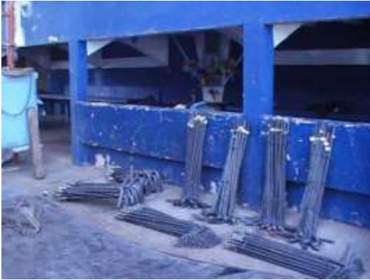
FABRICACION DE ANCLAS DE 1" Y 1 ¼" DIAM.
