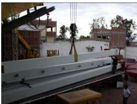
Fabricación de columnas a base de 4 placas para Procter & Gamble Proyecto “LAGER”
