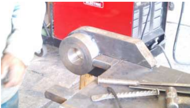
FABRICACION DE MUELLES EN PLACA DE 2" ESP. PARA SECADOR
