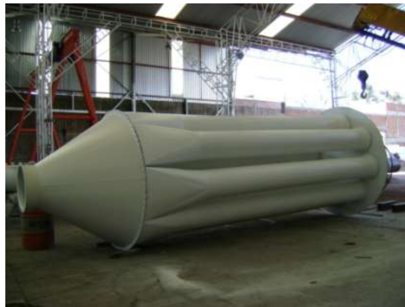
Acondicionador de Gases
