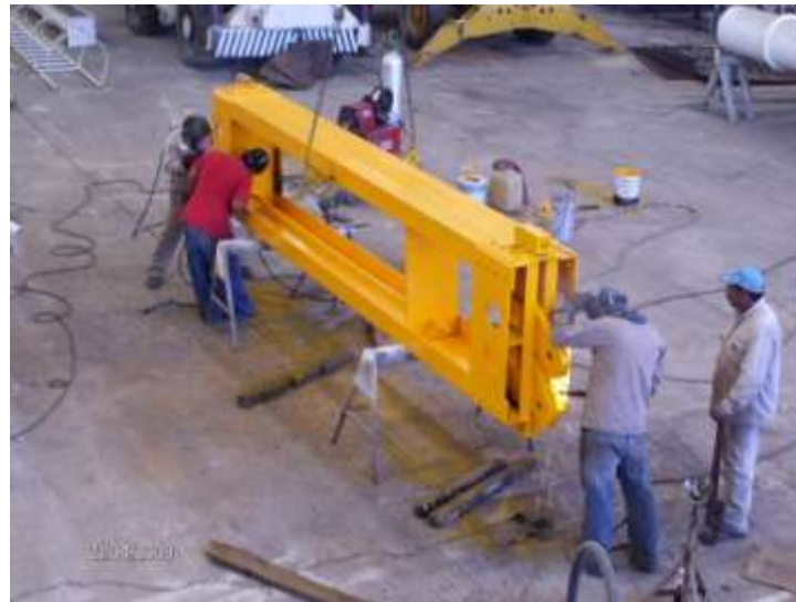
Fabricación de contrapeso para elevador de personal industria minera
