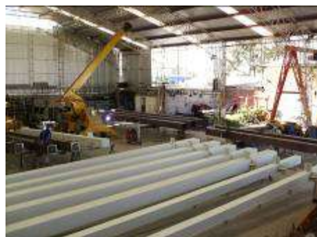
Fabricación de columnas a base de 4 placas para Procter & Gamble Proyecto “LAGER”
