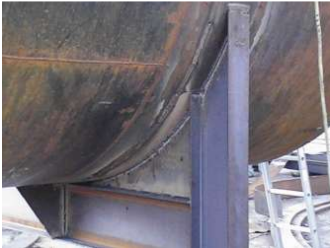
FABRICACION DE TANQUES DE ALMACENAMIENTO CON CAPACIDAD DE 60,000 LTS. PARA ALMACENAMIENTO DE ACEITE TERMICO.
