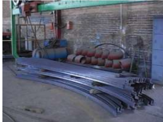
ROLADO Y CONFORMADO DE ANGULO.
